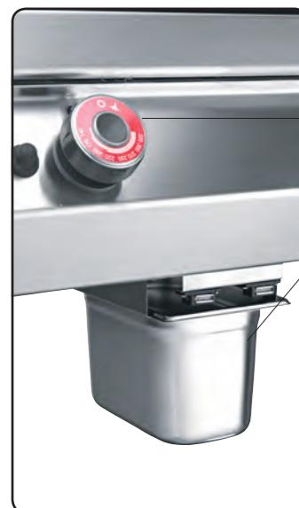
Manopole in nylon caricato a vetro con inclinazione utile per evitare infiltrazioni di liquidi e residui di cibo
